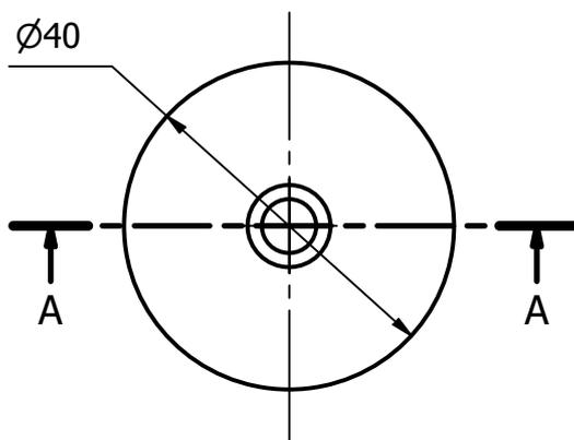
N.B: per il fissaggio si consiglia l'uso di viti a testa svasata con diametro nominale inferiore all' M6.
