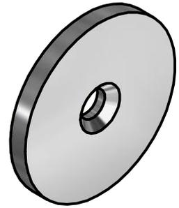
N.B: per il fissaggio si consiglia l'uso di viti a testa svasata con diametro nominale inferiore all' M6.
