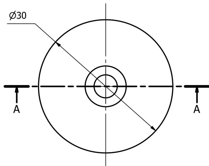
N.B: per il fissaggio si consiglia l'uso di viti a testa svasata con diametro nominale inferiore all' M5.
