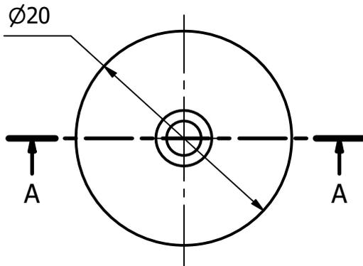
N.B: per il fissaggio si consiglia l'uso di viti a testa svasata con diametro nominale inferiore all' M3.
