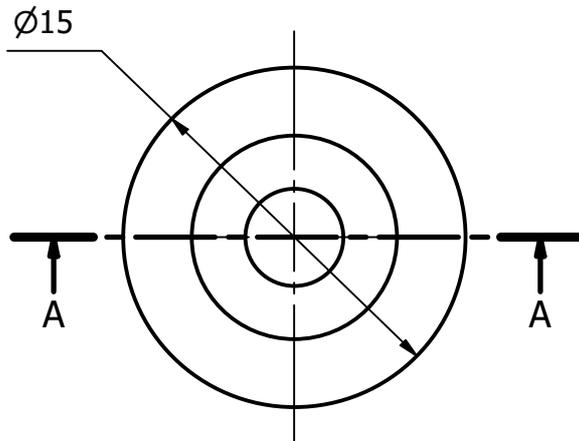
N.B: per il fissaggio si consiglia l'uso di viti testa svasata con diametro nominale inferiore all' M4.
