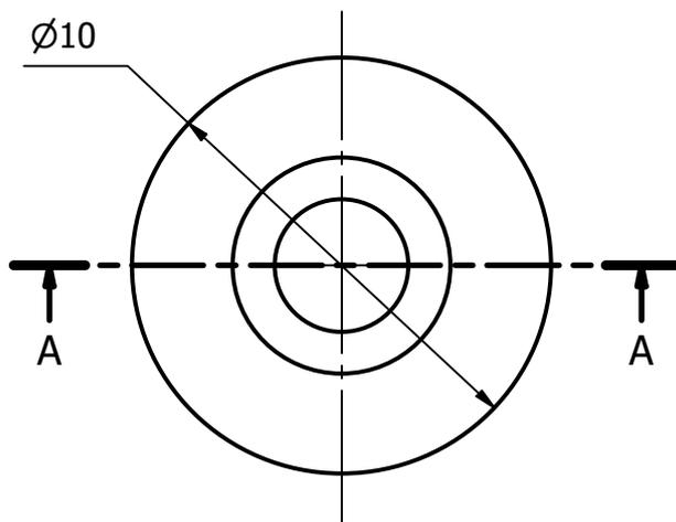
N.B: per il fissaggio si consiglia l'uso di viti a testa svasata con diametro nominale inferiore all' M3.
